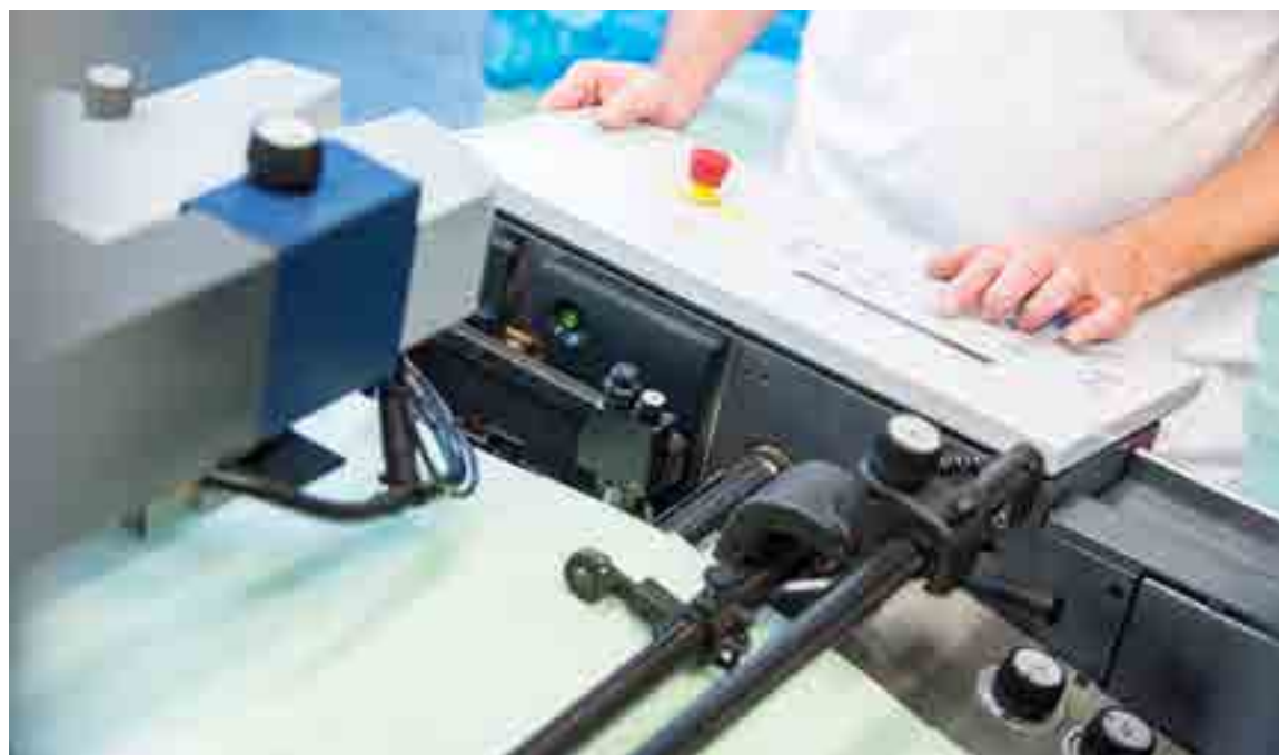
Met deze offset speedmaster van Heidelberg print Primus vierduizend vellen per uur. Naast offset kan de producent ook digitaal drukken en zeefdrukken.
